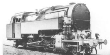
1929 1E1-Heißdampf-Tenderlokomotive Achsdruck: 19,8 t für die Sandbahn-Gesellschaft, Peiskretscham G/S.
