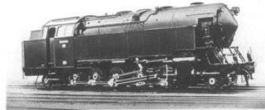
1935 1E1-Heißdampf-Tenderlokomotive, — Achsdruck: 20,4 t für die Sandbahn-Gesellschaft, Peiskretscham G/S.
