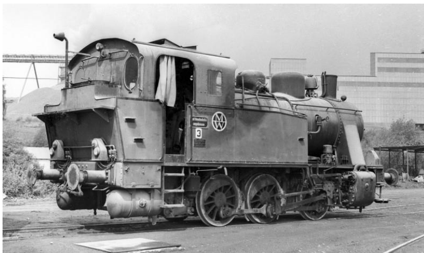
Möglicherweise die einzige Henschel-C400 mit einer Ölfeuerung zeigt dieses Bild aus der Sammlung von Rudolf Schlöpker. Die Lok 3 der Mannesmann Rohstoffwerke GmbH in Mettmann-Neandertal zeigt in der Rückansicht deutlich die Öffnungsklappe des Ölbehälters und ihre Verschlüsse. Der Ölvorwärmer war (hier nicht sichtbar) auf der Heizerseite der Maschine unterhalb des linken Wasserkastens angebracht. Die
