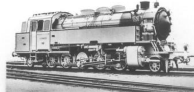
1937 1E1-Heißdampf-Tenderlokomotive — Achsdruck: 16 t für die Westfälische Landes-Eisenbahn.
