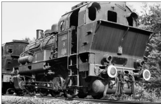
Bild 144 – Deutlich kann man bei der 1945 auf freier Strecke abgestellten Lok No. 9 die verdunkelten Laternen erkennen. AUFNAHME: SAMMLUNG HANS-DIETER JAHR
